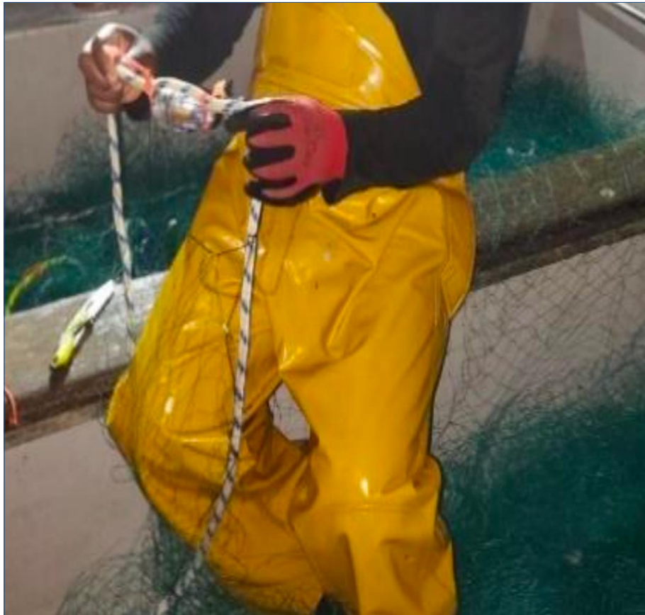
Figure 38 : LED UV accrochée parallèlement à la ralingue supérieure d'un filet trémail poissons avec de la cordelette (Source : Équipe TOPASE, CNRS)
