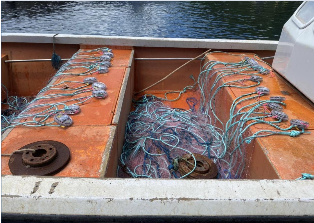
Figure 21 : Filets trémails à langoustes équipés de LEDs PISCES accrochées à la ralingue supérieure et espacées de 15 m sur les segments LEDs ON et LEDs OFF (Source : Équipe TOPASE, CNRS)
