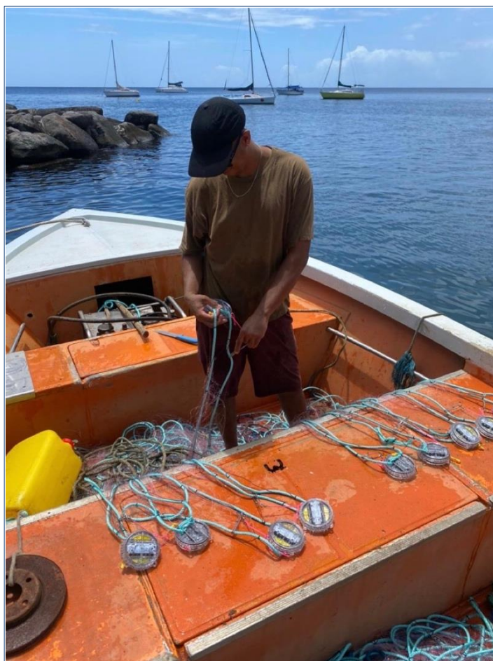
Figure 39 : Système d'attache des LEDs PISCES modifié par le marin-pêcheur (Source : Equipe TOPASE, CNRS)
