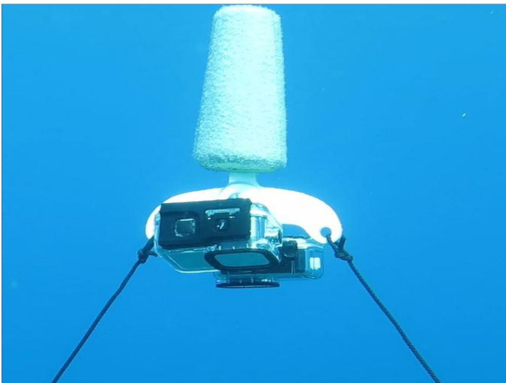
Figure 47 : Prototype optimisé pour la prise d'images sous-marines confectionné par le PNG permettant une meilleure compréhension du filet maillant de fond (Source : PNG)
