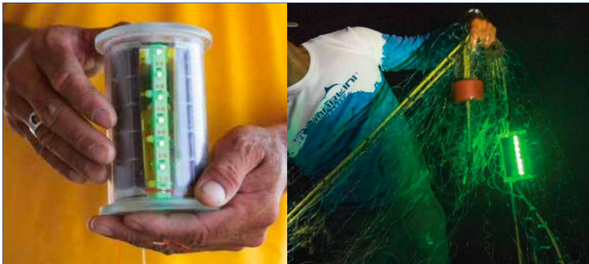
Figure 40 : Prototype de LED rechargeable à l'énergie solaire développé par Senko et al. (s.d.)
